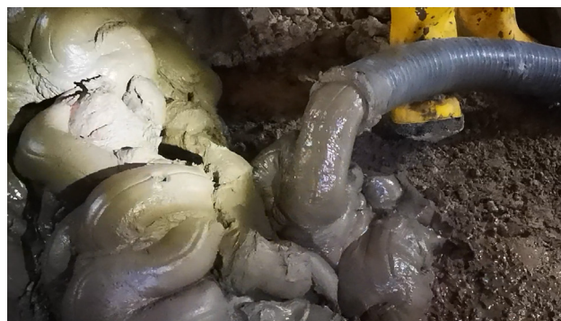
Bild 3: Schlauchtest 30 m mit RASCOhybrid HMS317
