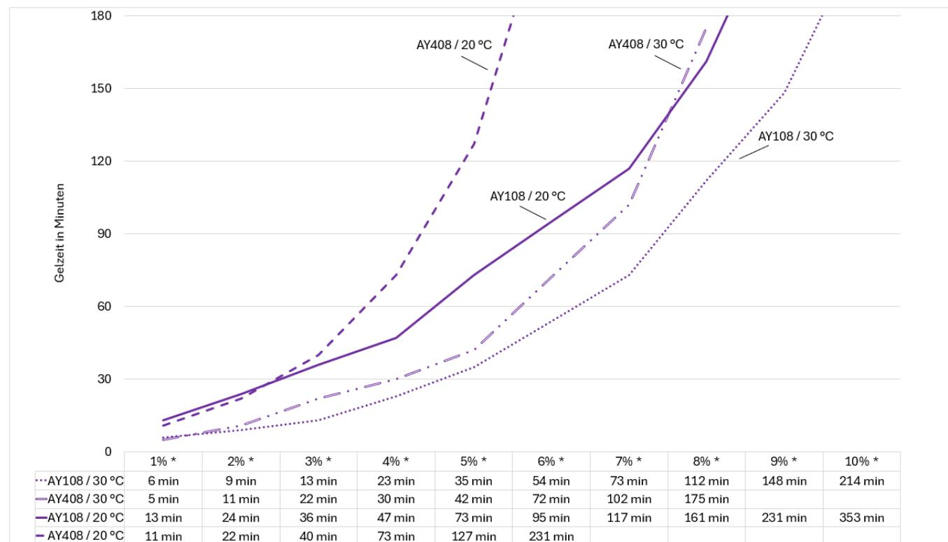
\* Zugabe in % von RASCOflex AY-RE24 in A-Komponente.
